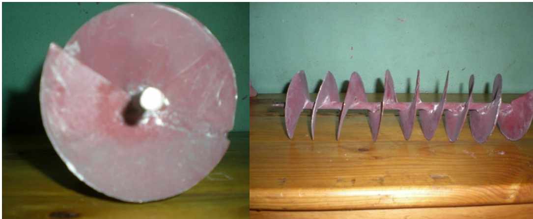
Figure N° 26. Formation de la vis sans fin
