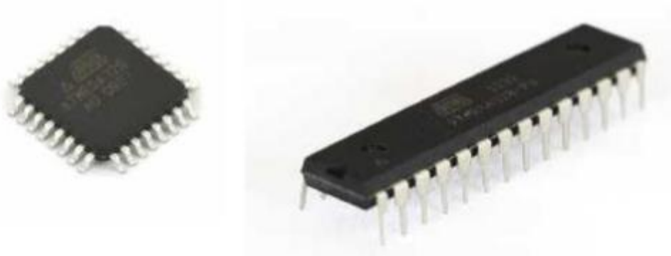
Figure N° 5. Microcontrôleur ATmega328 avec composant CMS à gauche et composant classique à droite
