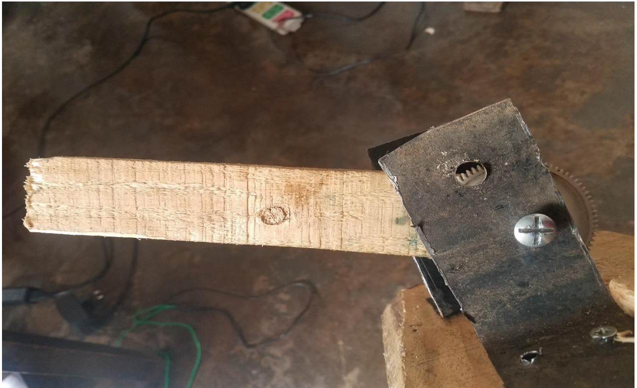
Figure 3.03 : Premier segment du robot
