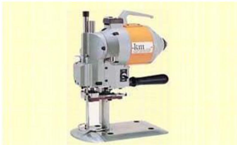
**Figure II-4:** coupeuse à lame verticale [2]
