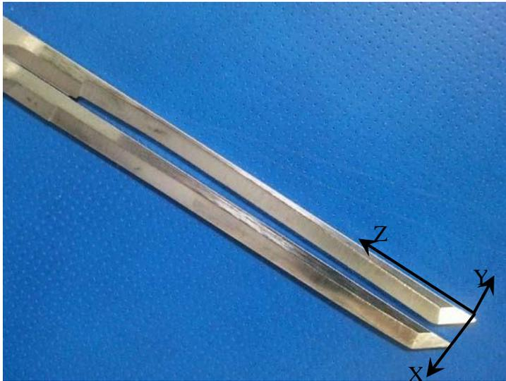
**Figure IV-1:** Comparaison d'une lame neuve (en bas) et une lame en vie de vie (en haut) [31]
