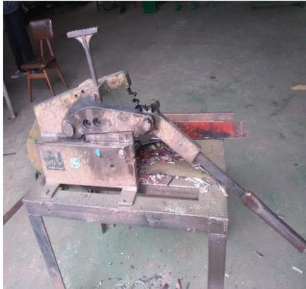
**Figure 9 :** Cisaille à levier mécanique (Source : Auteur)
