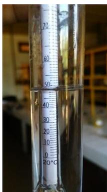
Photo 7 : Lecture du degré d'alcool avec un alcoomètre
