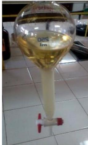
Photo 14 : Séparation des phases dans une ampoule à décanter
