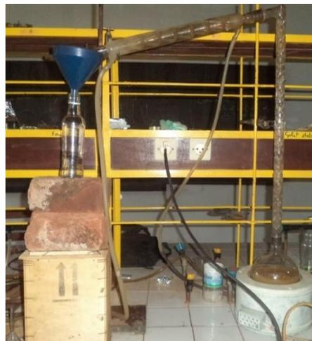
Photo 8 : Montage de la distillation fractionnée
