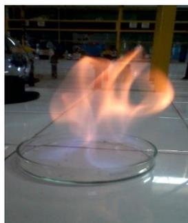
**Photo 11 : flamme observé lors de la combustion de l'éthanol obtenu**
