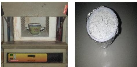
Photo 9 : mise en étuve de la chaux et chaux activée
