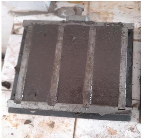
*Photo 20: moulage des éprouvettes*
