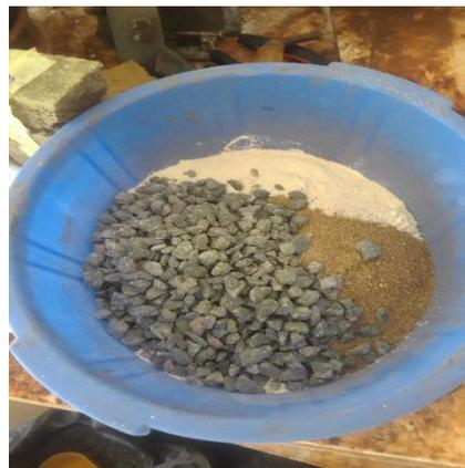
*Photo 18: malaxage de l'aluminosilicate et les agrégats (AS + agrégats)*
