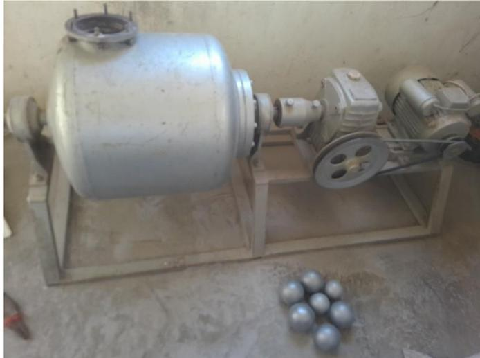
*Photo 2: broyeur à boulet du CNRIT*
