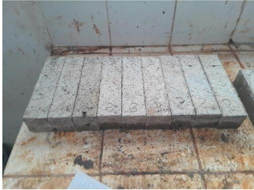
Photo 21: Séchage des éprouvettes
