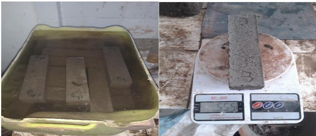
*Photo 23: Mesure de la porosité*
