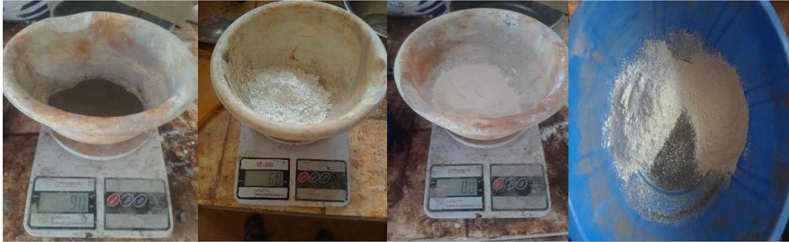
*Photo 17: pesage des constituants de l'aluminosilicate et mélangeage*
