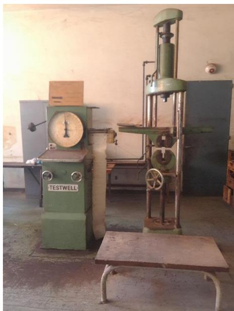
Photo 24 : Machine d'essai Mécanique « Wolpert TESTWELL »
