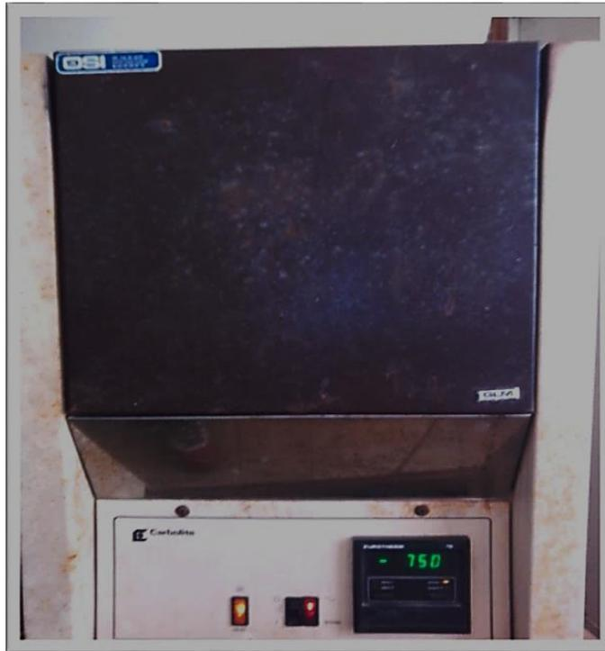
Photo 5: Four de calcination du kaolin à 750°C
