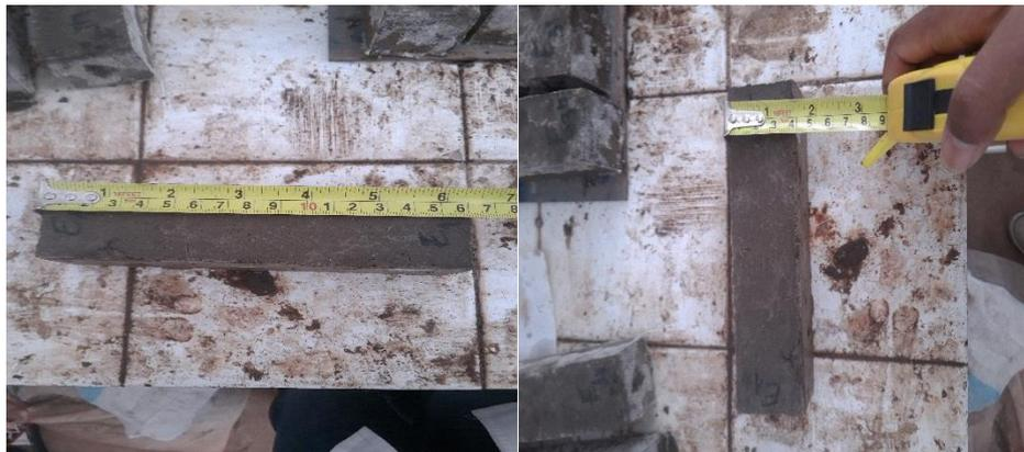
Photo 22: Mesure du retrait à l'aide d'un mètre graduée
