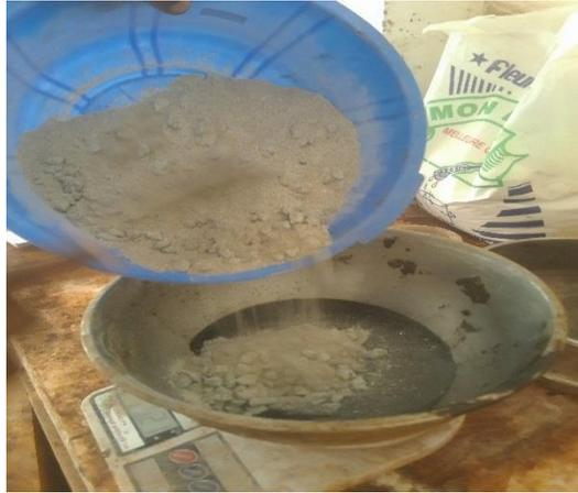
*Photo 19: mélangeage de l'aluminosilicate et du silicate de soude*
