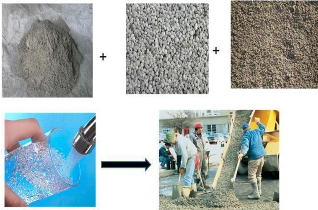
Figure 1: les éléments constitutifs d'un béton :
