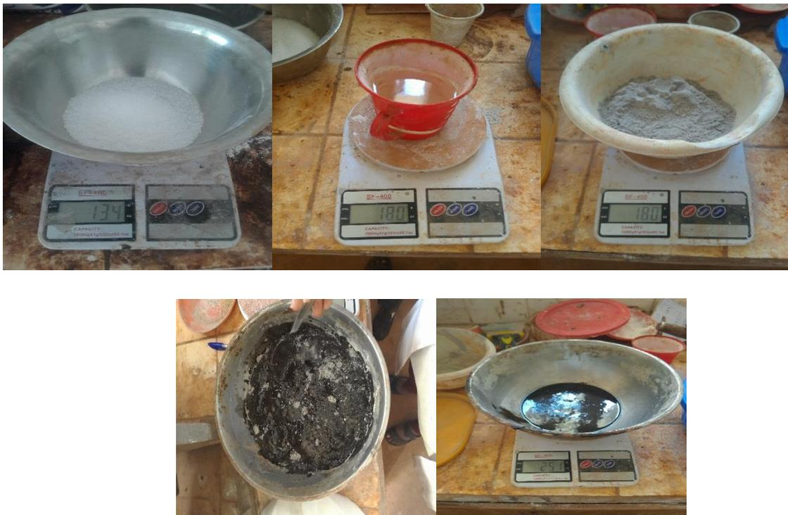
*Photo 16: pesage et mélangeage de silicate de soude*
