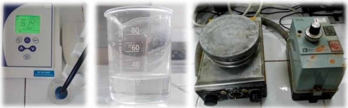
Figure 15 :pH-mètre, bécher 100 ml et agitateur magnétique
