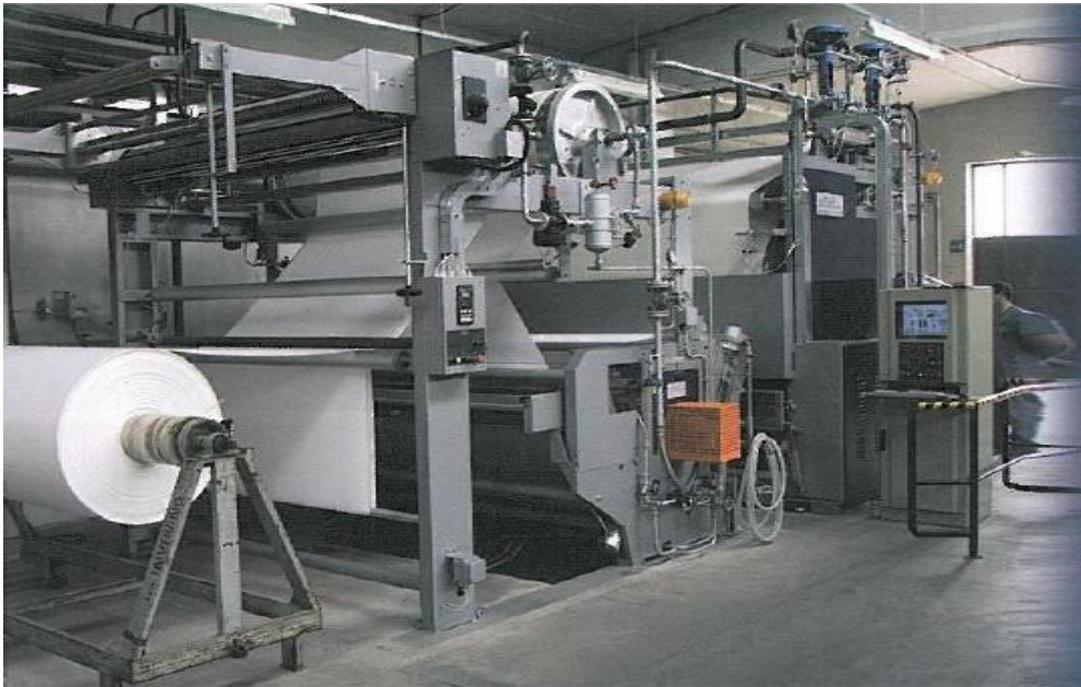
Figure III.9 : Machine à Sanforiser
