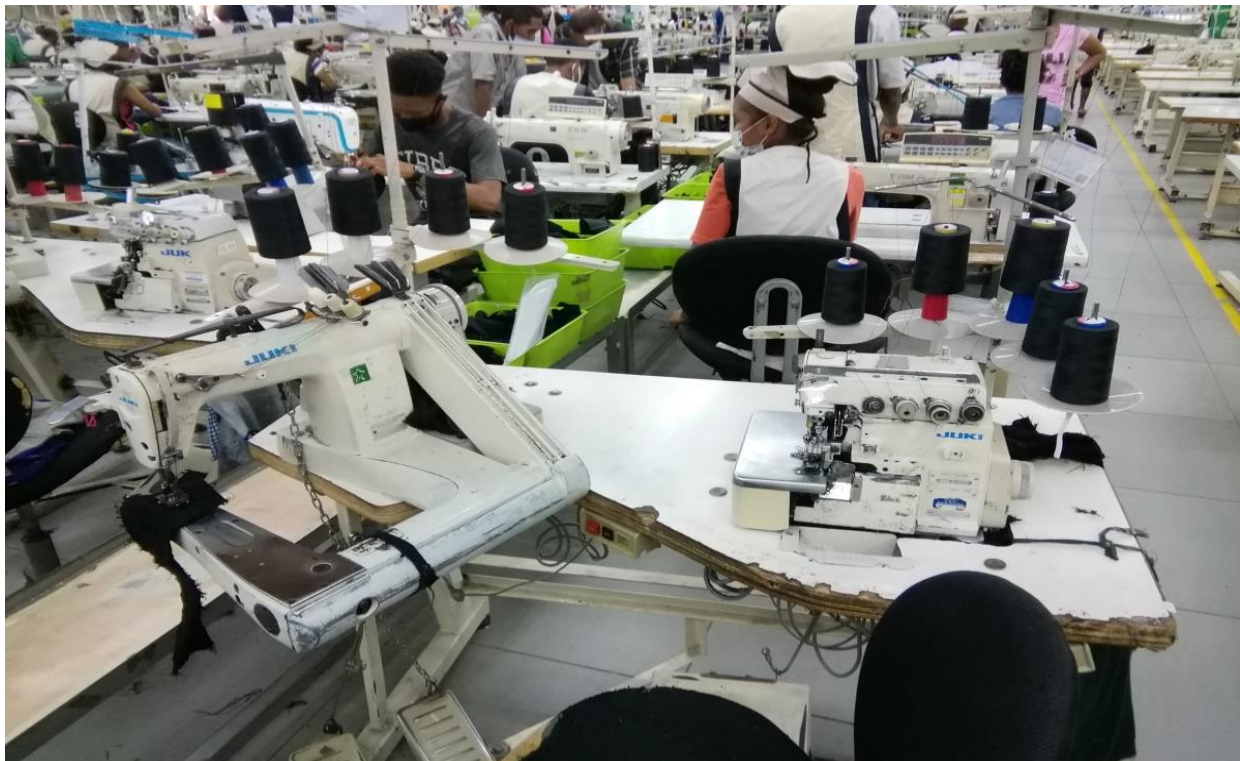
Figure IV-10: Deux types de machines qui sont placés dans la zone ergonomique de l'opérateur.
