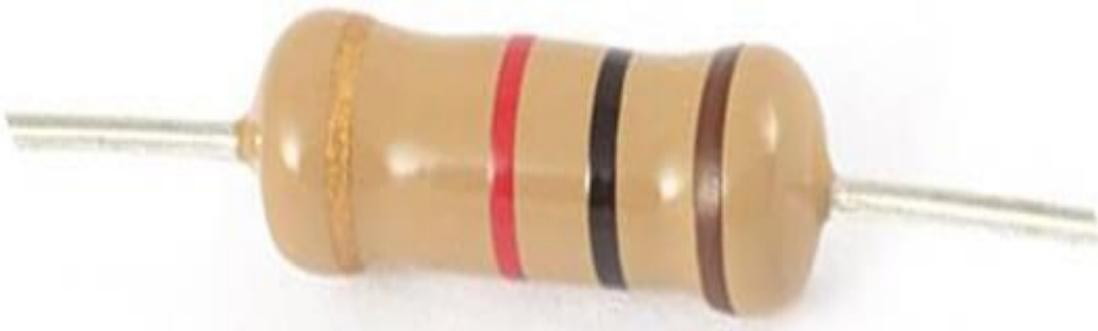
**Figure 3.09 :** Résistance au carbone [1.23].
