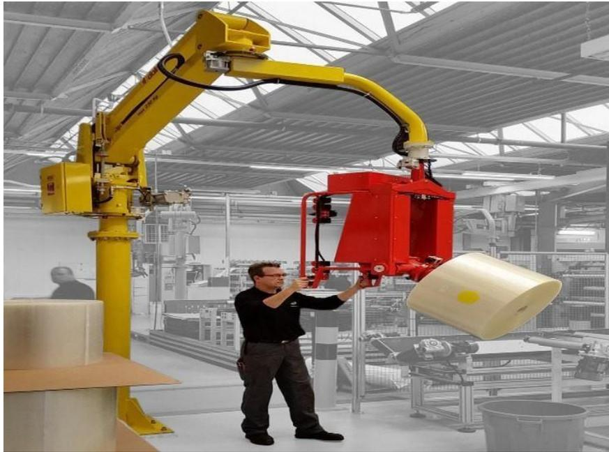
**Figure 1.05 :** Manipulateur à commande manuelle [1.08]
