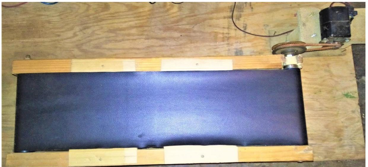
**Figure 3.12 :** Convoyeur à bande réalisé
