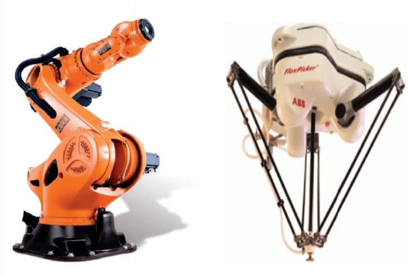
**Figure 1.02 :** Bras manipulateur série et bras manipulateur parallèle [1.05].
