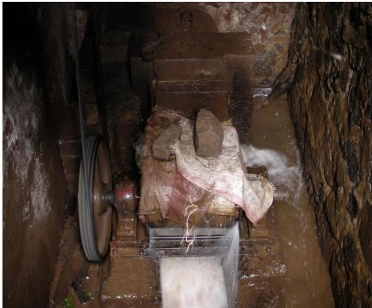
*Figure 23 : turbine artisanale de type à action*
