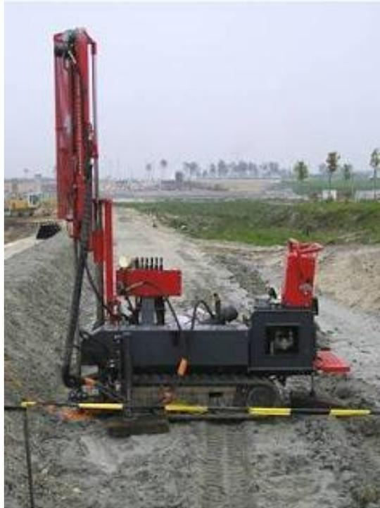
Figure 8: Appareil utilisé en « essai au PENETROMETRE» (source [f])
