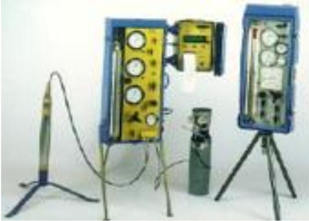
Figure 7: Appareil utilisé en « essai PRESSIOMETRIQUE » (source [f])
