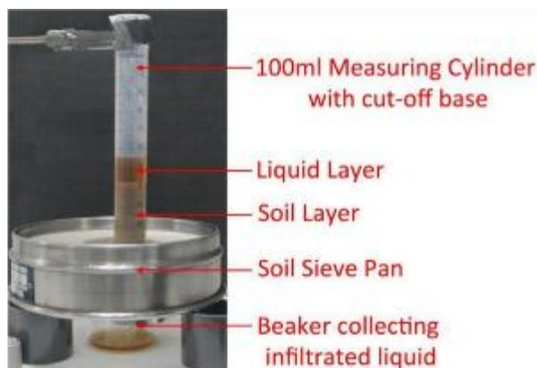
Figure 12. Configuration expérimentale pour la deuxième méthode de calcul de la conductivité hydraulique.
