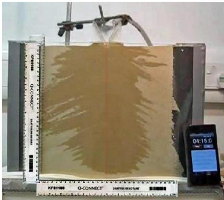
Figure 24. Capture d'image de l'expérience finale (à 4 minutes 15 secondes) pour l'eau s'écoulant dans du sable fin.
