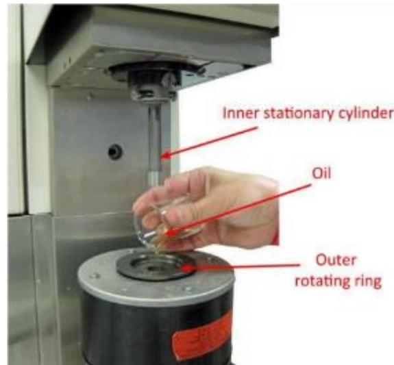
Figure 8. Équipement utilisé pour la détermination mécanique de la viscosité de l'huile (TA Instruments, Rheometric Scientific, ARES).
