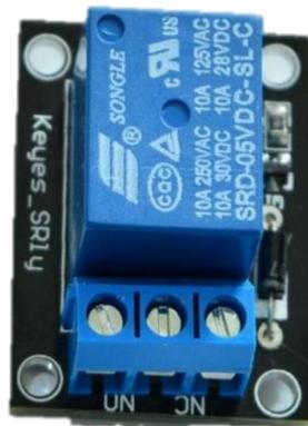
Figure 2.23 : . Le relai utilisé dans notre projet.
