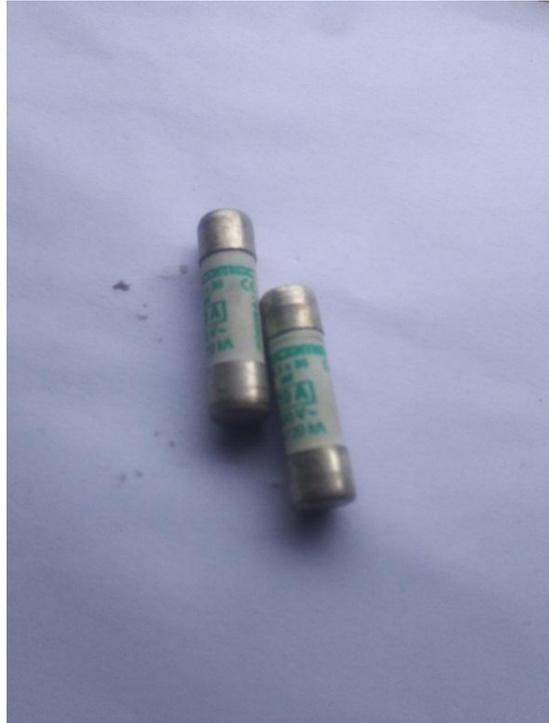
Figure 2.32 : Les fusibles SOCOMEC.
