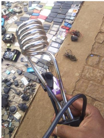
Figure 2.22 : La résistance de chauffage.
