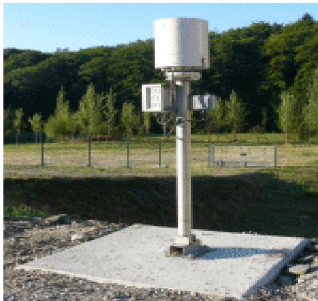
Figure 1.16 : Un pluviomètre à augets électronique [1.16].
