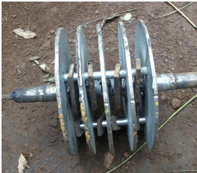
Figure N° 17. Rotor du broyeur en premier essai
