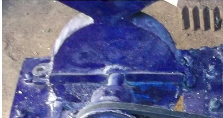
Figure N° 14. La chambre de broyage
