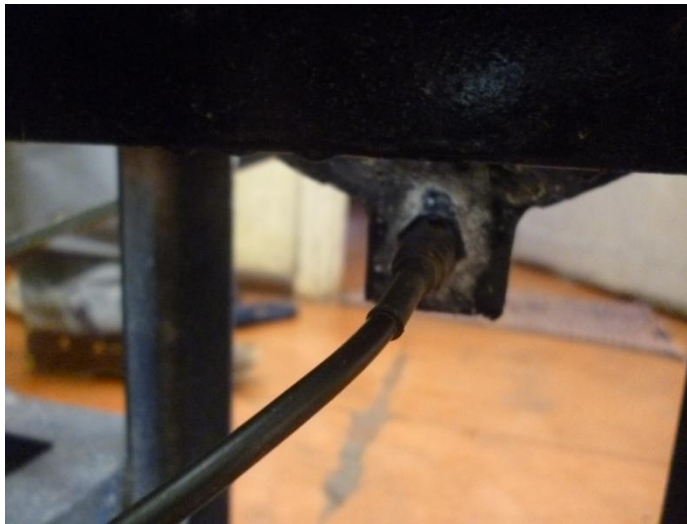
Figure N° 25. L'emplacement de la sonde DS18B20
