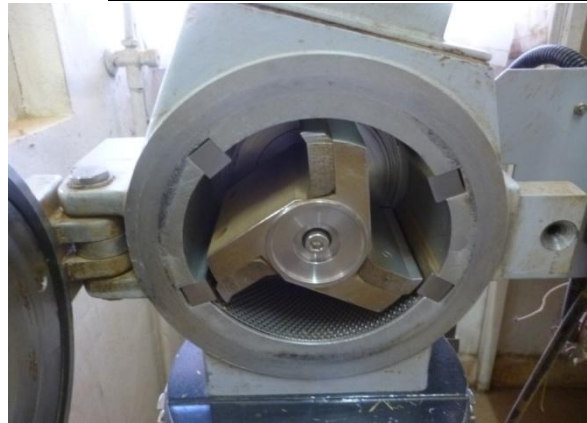
Figure N° 1. Chambre de broyage d'un broyeur à couteaux.
