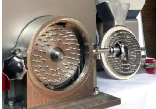
Figure N° 3. Chambre de broyage d'un broyeur à broches
