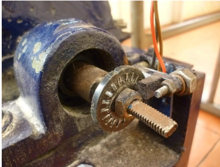
Figure N° 26. L'emplacement du capteur H206 et le disque DZ186
