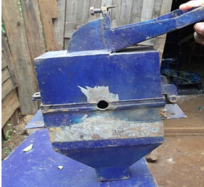
Figure N° 16. Corps du broyeur en premier essai
