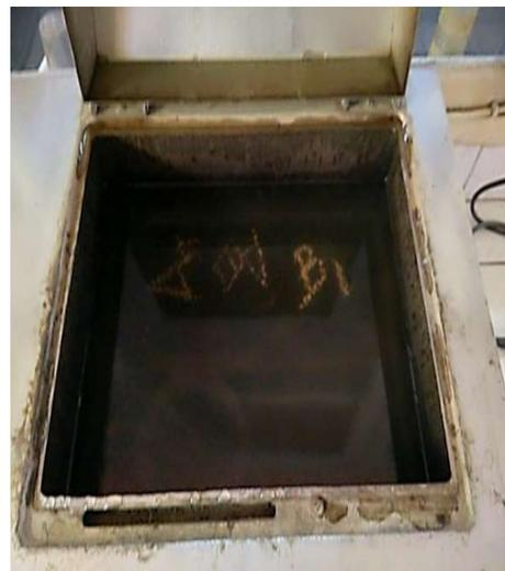
*Photo 13 : immersion dans un bain thermostatique*
