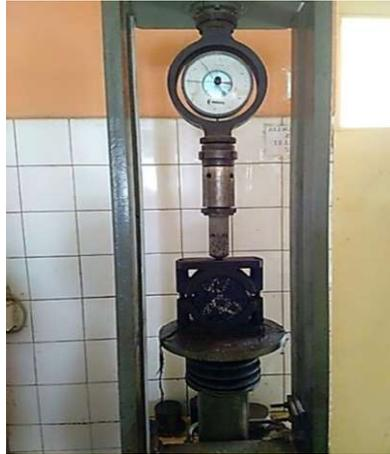
*Photo 14 : Ecrasement de l'éprouvette*
