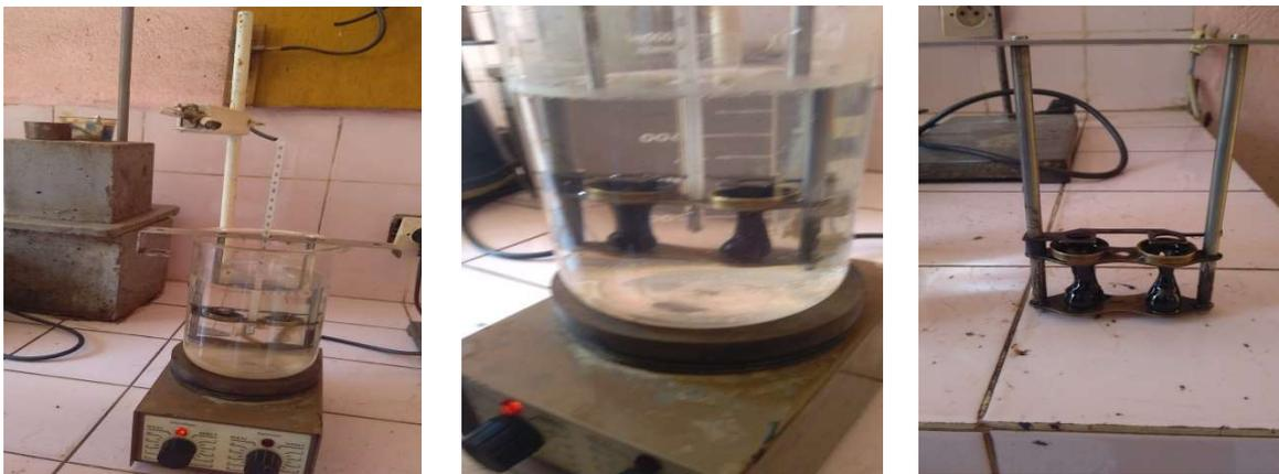
*Photo 6 : Appareils de mesure de la température bill-anneau*
