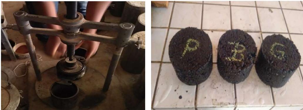
*Photo 11 : Démoulage des éprouvette*
