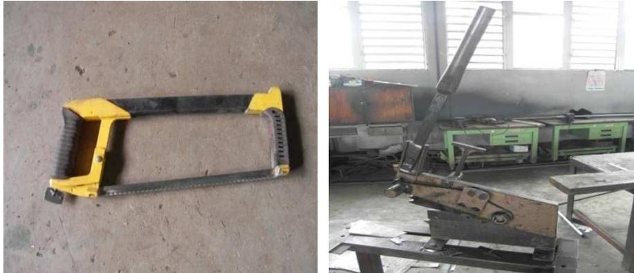
Scie à métaux avec lame à gauche et cisaille manuelle à gauche.
