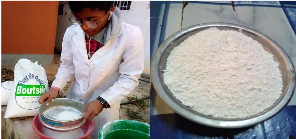
Photo 4 : Tamisage de la chaux au tamis 0.4mm
