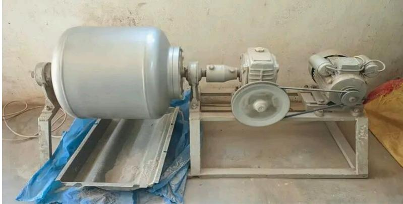
Photo 10 : Broyeur à boulet
