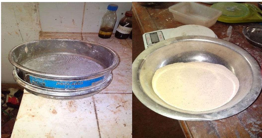
Photo 1 : Tamis de 0.4mm d'ouverture    Photo 2 : Sciure de bois tamisé à 0.4mm d'ouverture
