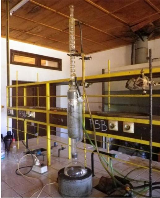
Figure 10 : Montage de soxhlet pour l'extraction
