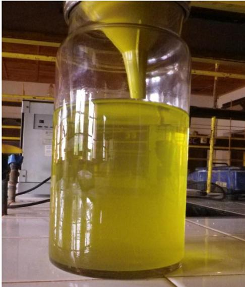
Figure 12 : Filtration de l'hexane contenant les substances extraites
