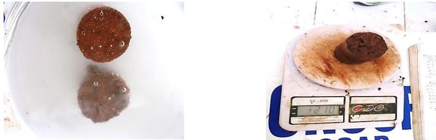
Photo 32 : Immersion de l'échantillon dans l'eau et pesage humide
