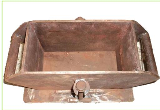
Photo 37 : Moule de la brique compressé
