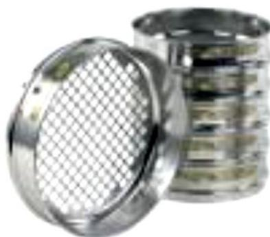
**Figure 4 : Un tamis pour l'analyse granulométrique**
