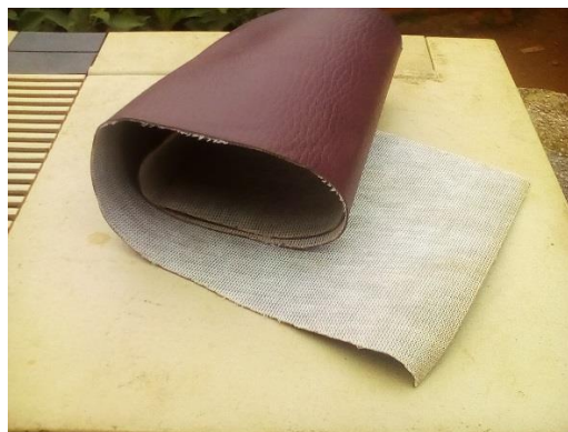
Photo 1: bande à carcasse textile
