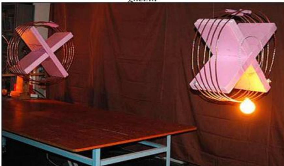
Photos 1.1 Photos d'un système de transmission d'énergie sans fil [WiTricity - The Wireless Power Transfer, june 2007] [1]
