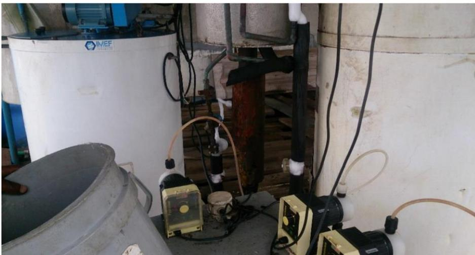
**Photo 14 Machine à glace marque IMEF avec les pompes doseuses de saumure et de solution bicarbonate**
