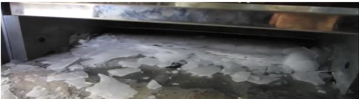
**Photo 13 Principe de raclage de glace congelé sur la surface de l'évaporateur**
