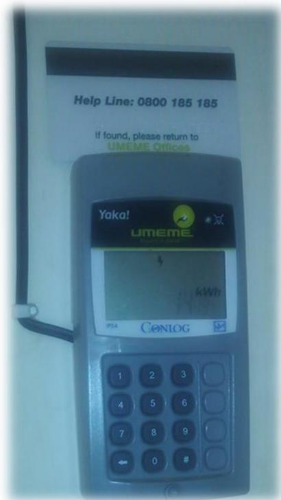
*Figure 3.9 : Clavier et écran d'un compteur prépayé de l'UMEME*
