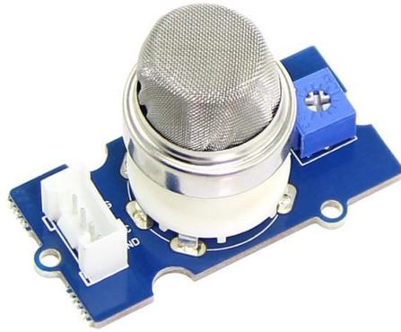
*Figure 2.23 : Capteur de gaz*
