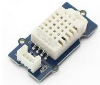
Figure 2.22 : Capteur température et Humidité 12C
