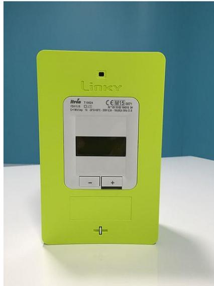
Figure 1.7 : Compteur communiquant Linky.
