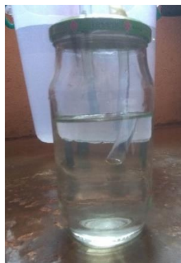
Figure 5.05 : Déshumidification de l'hydrogène sortie de l'électrolyseur
