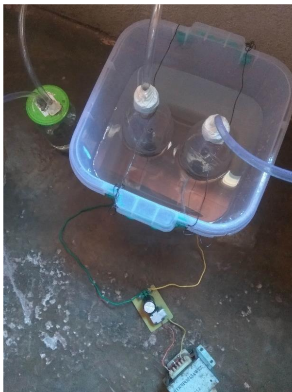
Figure 6.06 : Montage de l'électrolyseur avec alimentation 30V
