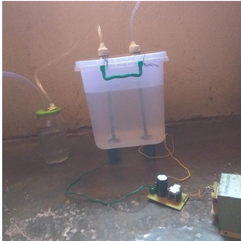
Figure 6.04 : Montage de l'électrolyseur avec alimentation 21,8V
