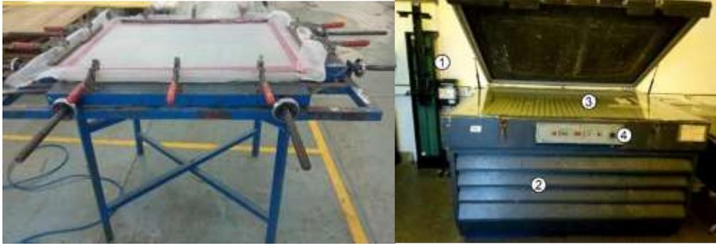
**Figure III. 6 : Entendeur d'écran, la machine d'enduction et table d'insolation [9]**
