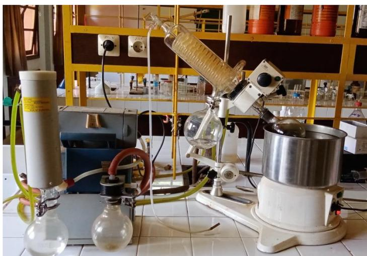
Figure V.01 : Photo d'un rotavapor
