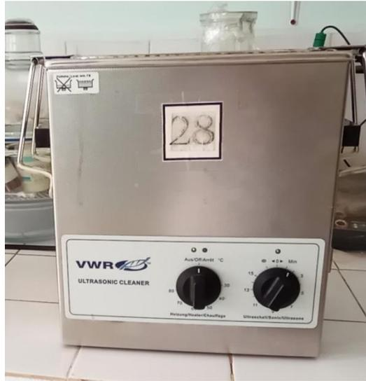
**Figure VII.02 : Photo d'un bain ultrason**
