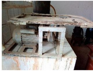
**Photos 12:** Table vibrante de 1000 à 2000 vibrations par minutes
