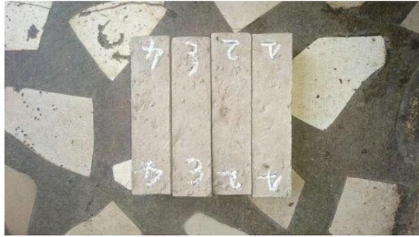
**Photos 37:** Béton géopolymère après immersion dans l'acide chlorhydrique pendant 14 jours
