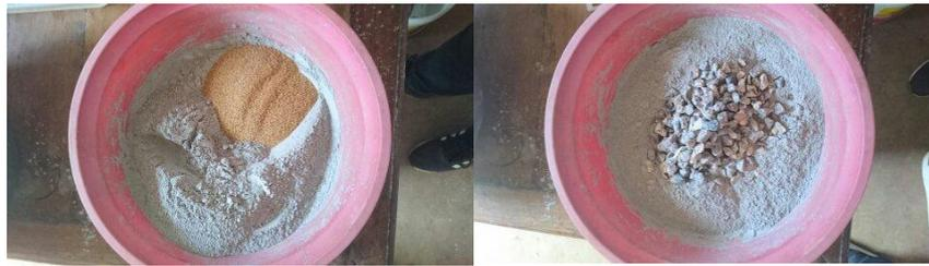
**Photos 27:** mélange d'aluminosilicate, chaux et gravier
