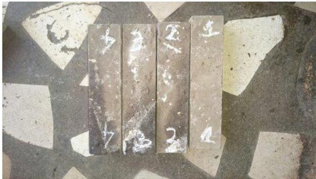
**Photos 38 :** Béton géopolymère après immersion dans l'acide sulfurique pendant 14 jours
