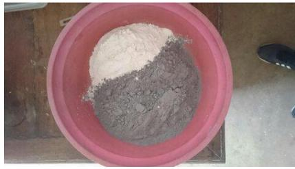
**Photos 26:** mélange d'aluminosilicate et chaux
