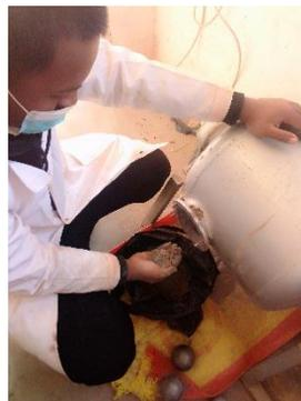
**Photos 9:** Broyeur à boulet
