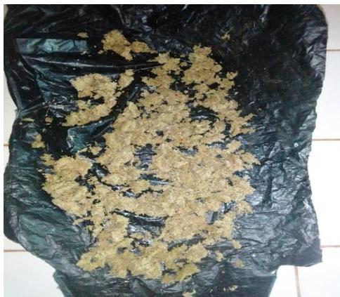
Figure 36 : Drêche issue de l'hydrolyse (source : Auteur)
