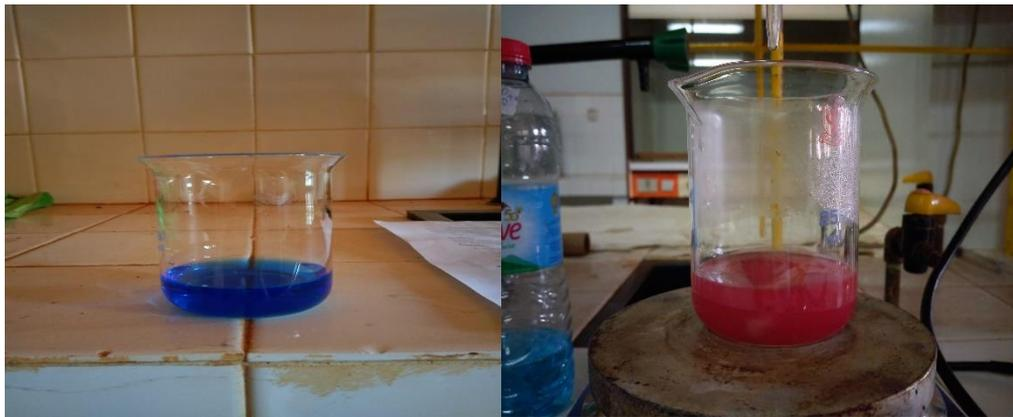
Figure 43 : Solution avant et après dosage (source : Auteur)
