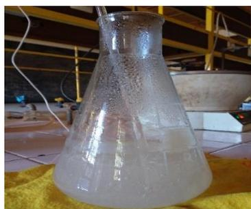
Figure 35 : Solution visqueuse ou amidon gélifié (source : Auteur)
