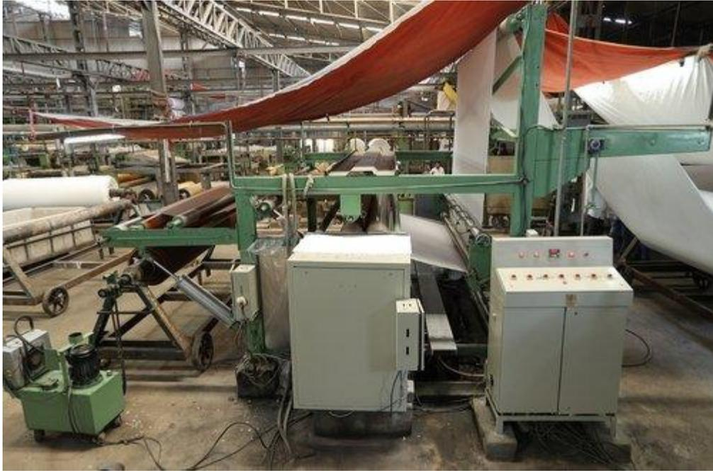
Figure 21 : Schéma représentatif d'un Pad Batch
