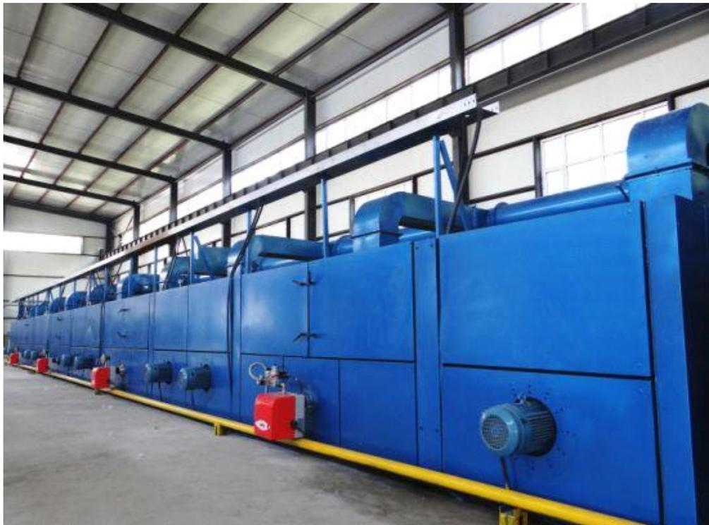
Figure 22 : Schéma représentatif d'un Hot flue
