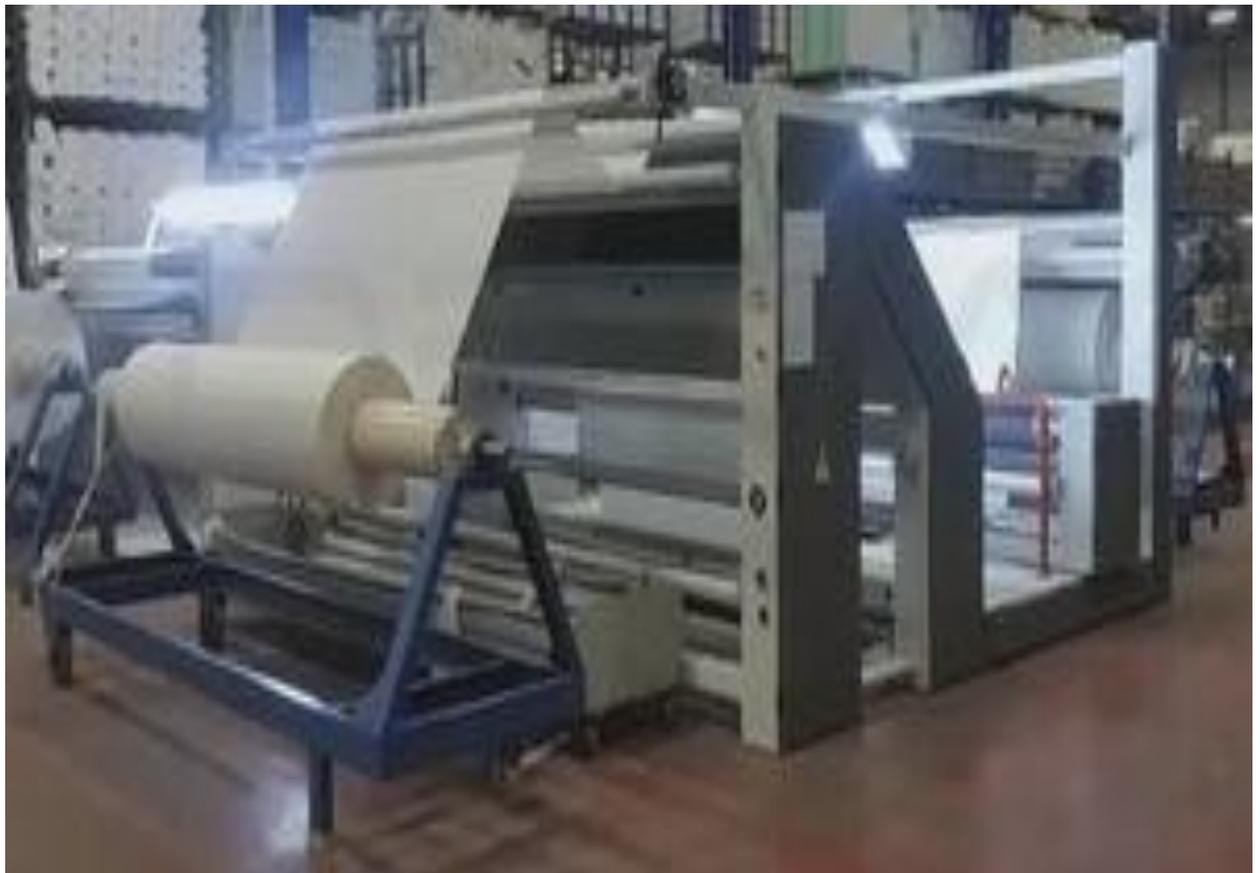
Figure 29 : Schéma représentatif d'une flambeuse
