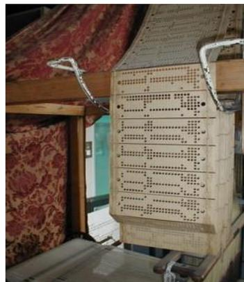
Figure I. 4 : Système à cartes perforées [2]
