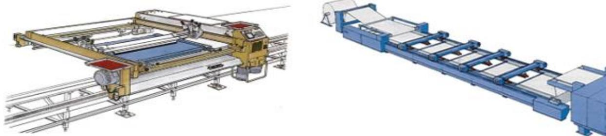
Figure I. 21 : Machine d'impression au cadre plat [10]
