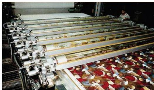
Figure I. 22 : Impression au cadre rotatif [7]
