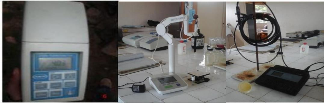
Figure 18: Turbidimètre, pH-mètre, conductimètre [Auteur]
