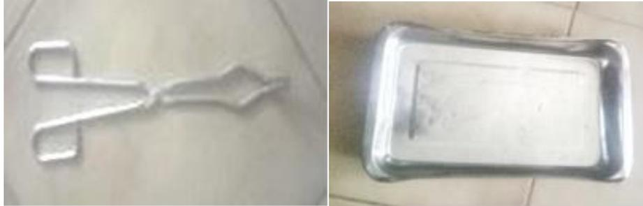
**Photo 24 :** Pince à creuset et un plateau isolant
