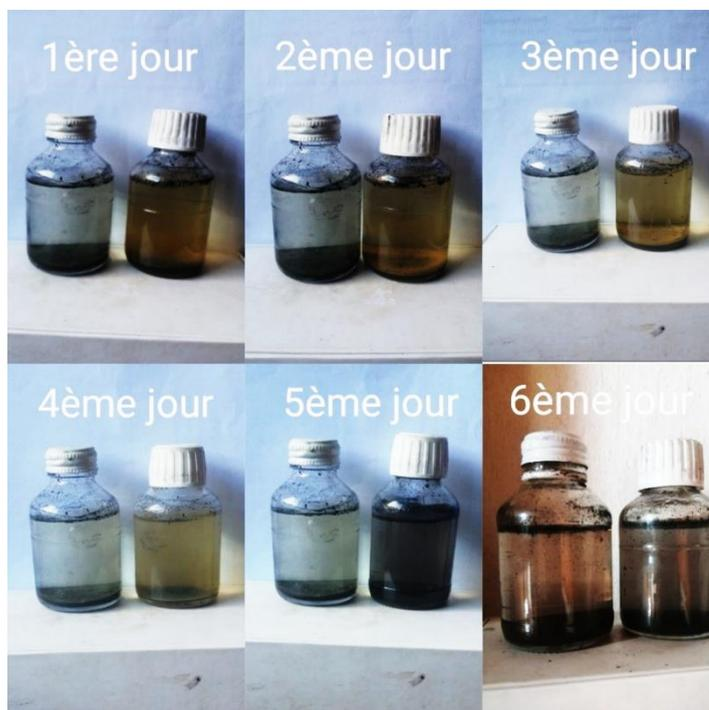
**Figure 15:** Test d'adsorption noir de carbone et Charbon Actif
