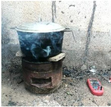
Photo 49 : Test d'ébullition d'eau
