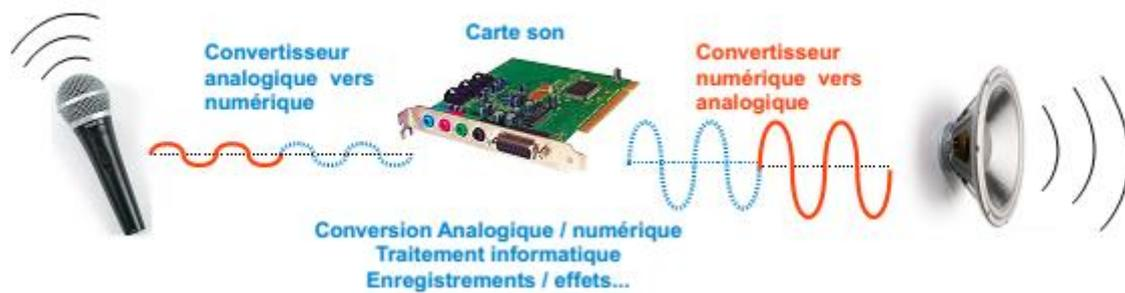
**Figure 2.06 :** Exemple d'une chaîne numérique
