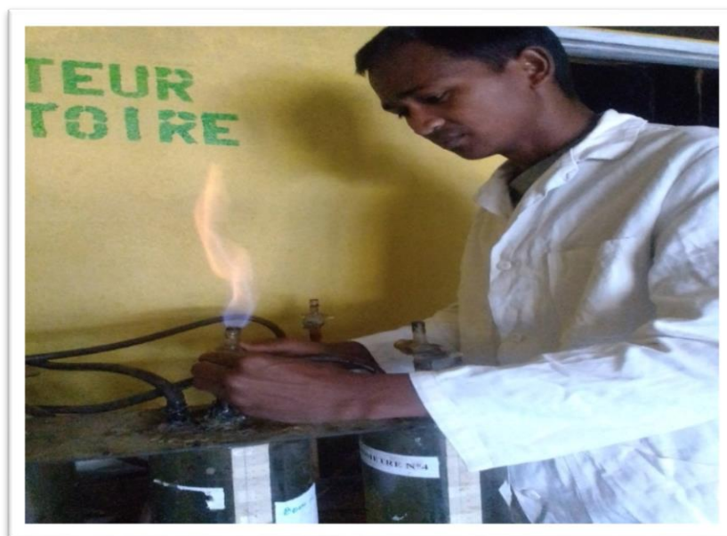
Photo 7 : Flamme du biogaz en dessus du gazomètre Source : Auteur [25.10.22]
